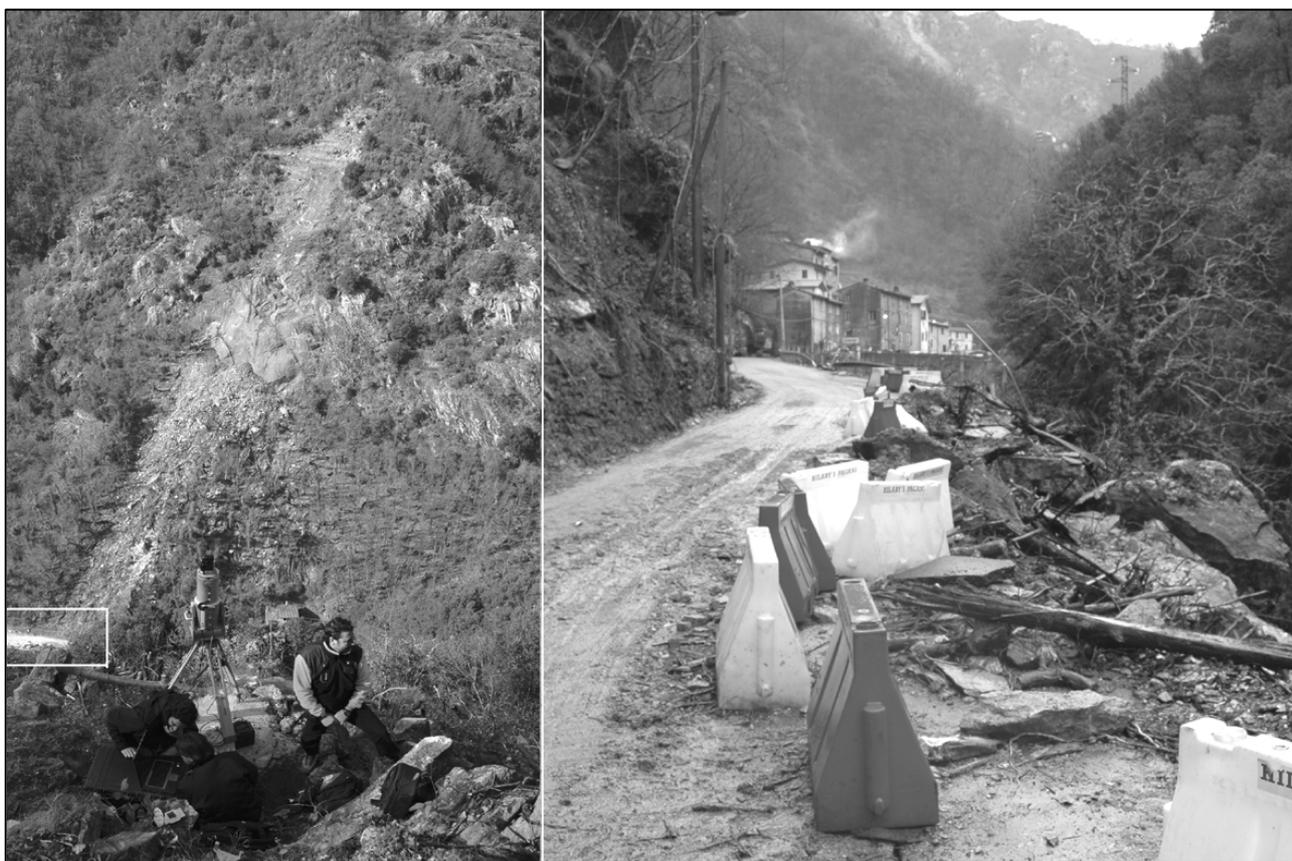
*Figura 1 – Evento franoso del 27-28 Febbraio 2007 presso l'abitato di Guadine. A sinistra è possibile apprezzare il Laser Scanner utilizzato per la creazione del modello digitale del versante di elevata risoluzione spaziale*
